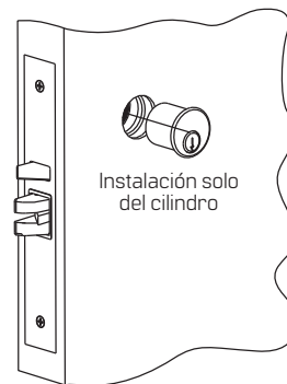
Figura 1 3 Instalación solo del cilindro
