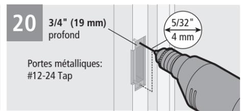
\* Pour les fonctions exigeant seulement des plaques de finition extérieures (comme le ZD et le ZR) et les fonctions exigeant seulement des plaques de finition intérieures (comme le XD et XR), préparer les trous de montage en applique de la plaque de finition du côté de la porte sur lequel celle-ci sera installée, selon le besoin.
