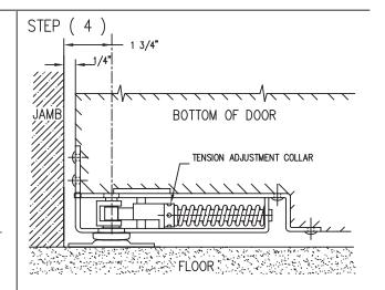
INSTALL THE SPRING PIVOT ASSEMBLY AS SHOWN.
