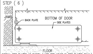
INSTALL SIDE PLATES AS SHOWN. ( USE TOP HOLES IN SIDE PLATES ONLY ) ATTACH BACK PLATE USING SELF TAPPING MACHINE SCREW.
