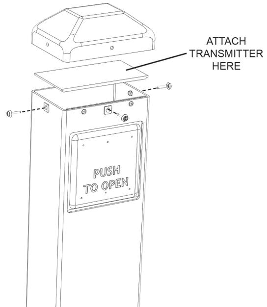
**CAUTION:** IF THE TRANSMITTER IS ALLOWED TO HANG DOWN INSIDE THE BOLLARD, ERRATIC OPERATION MAY OCCUR.
