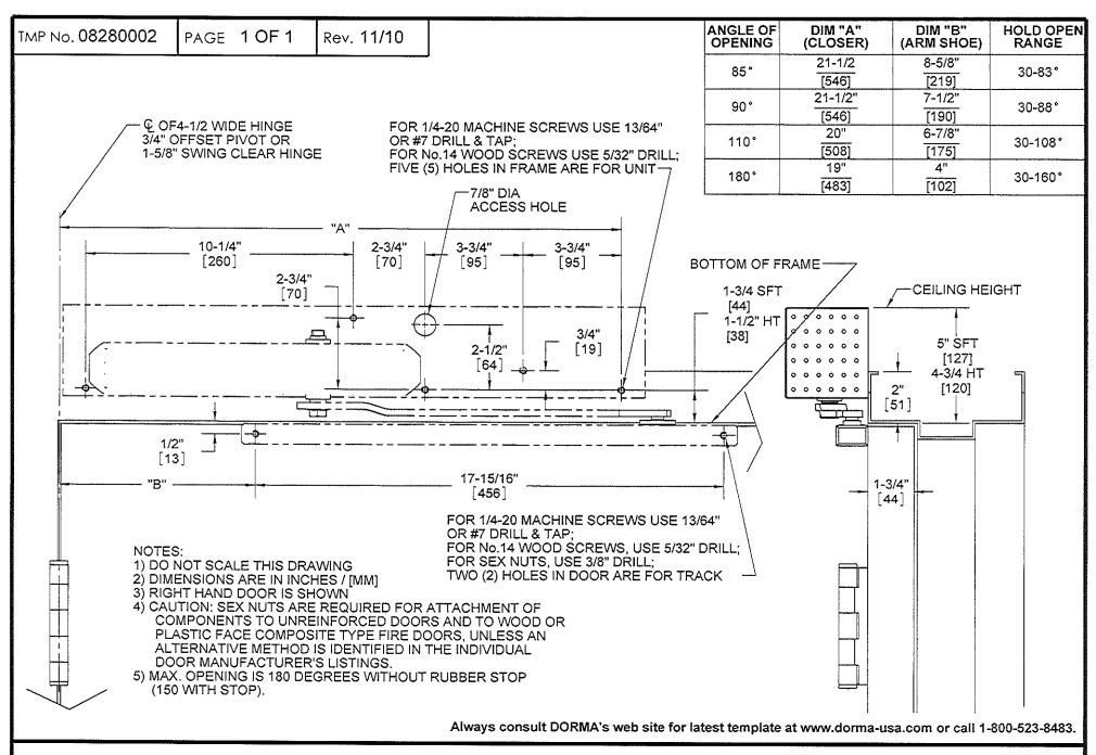
DOOR CLOSER MODELS: 1856 HT, 1856 SFT, 1856 HT SD, 1856 SFT SD TRACK INSTALLATION (PULL SIDE MOUNT- RIGHT HAND DOOR)
