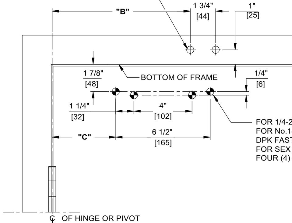
FOR 1/4-20 MACHINE SCREWS USE 7/32" DRILL
