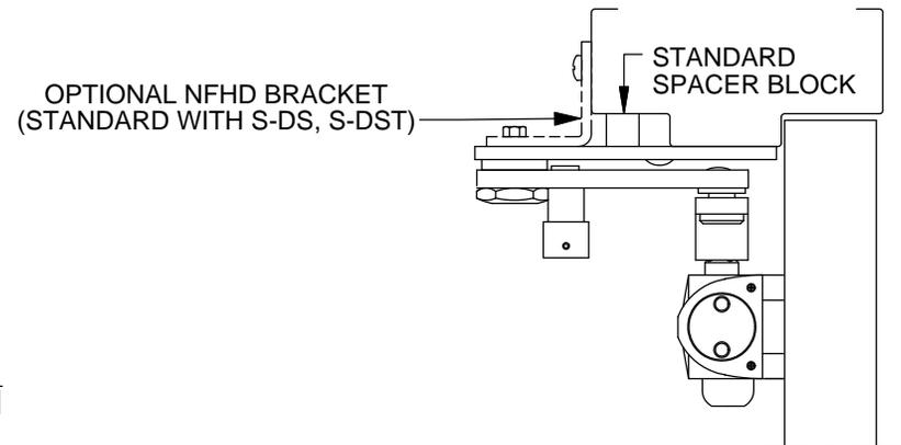
DOOR CLOSER MODELS: 7302 - 7305 DS, DST, DSK, S-DS, S-DST
