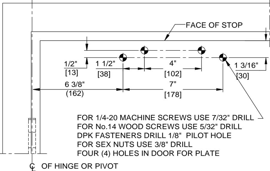
FOR 1/4-20 MACHINE SCREWS USE 7/32" DRILL
