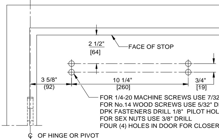
FOR 1/4-20 MACHINE SCREWS USE 7/32" DRILL
