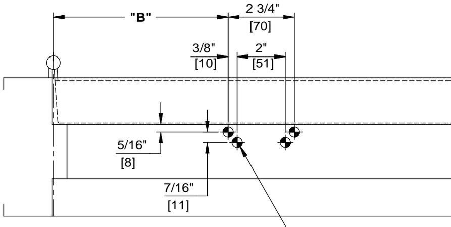
FOR 1/4-20 MACHINE SCREWS USE 7/32" DRILL
