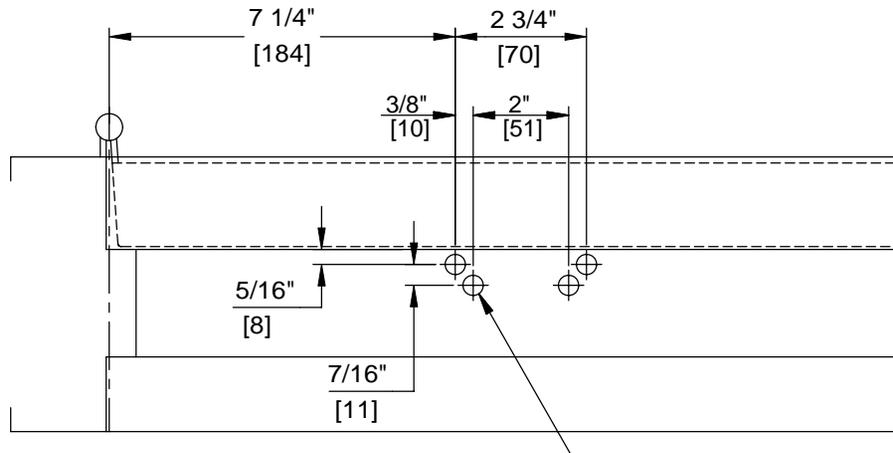
FOR 1/4-20 MACHINE SCREWS USE 7/32" DRILL
