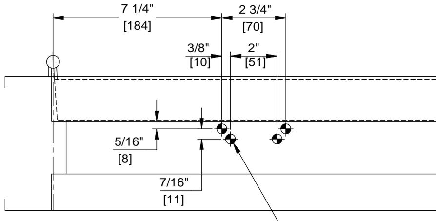
FOR 1/4-20 MACHINE SCREWS USE 7/32" DRILL
