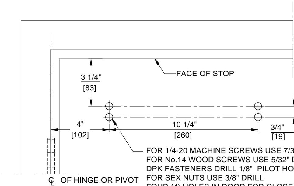
FOR 1/4-20 MACHINE SCREWS USE 7/32" DRILL
