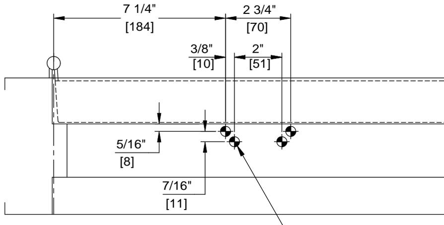
FOR 1/4-20 MACHINE SCREWS USE 7/32" DRILL
