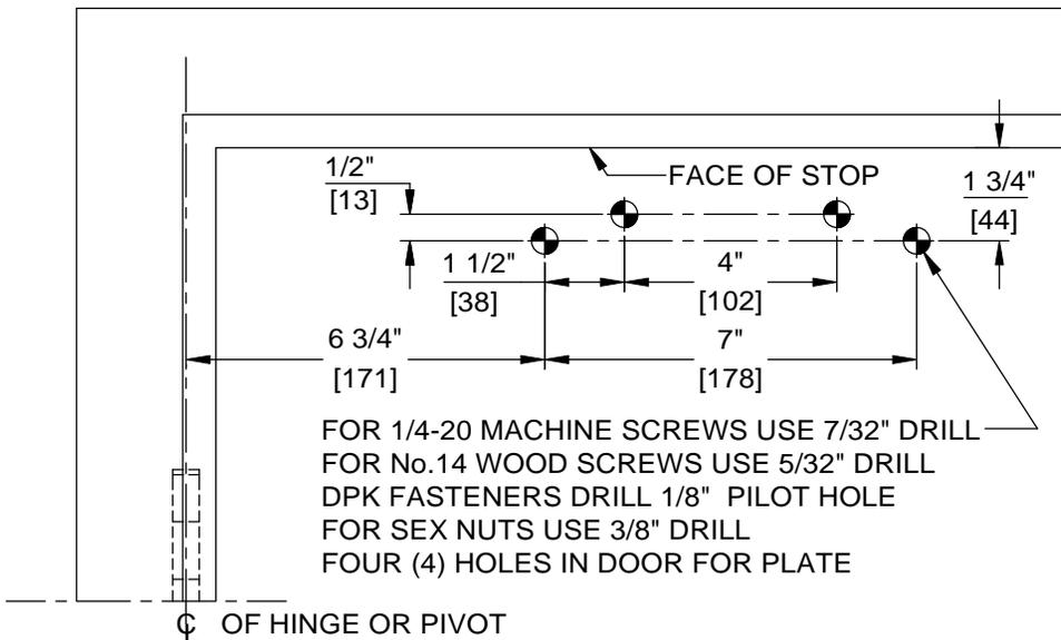
FOR 1/4-20 MACHINE SCREWS USE 7/32" DRILL
