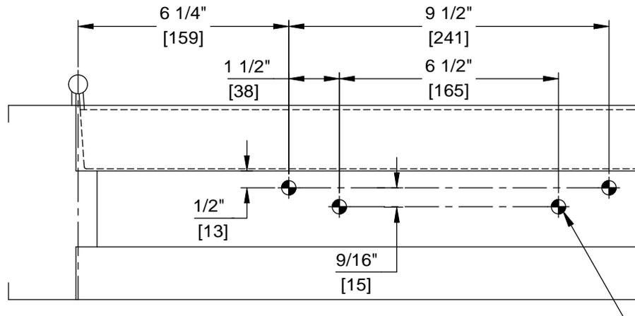
FOR 1/4-20 MACHINE SCREWS USE 7/32" DRILL
