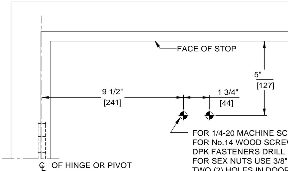
FOR 1/4-20 MACHINE SCREWS USE 7/32" DRILL
