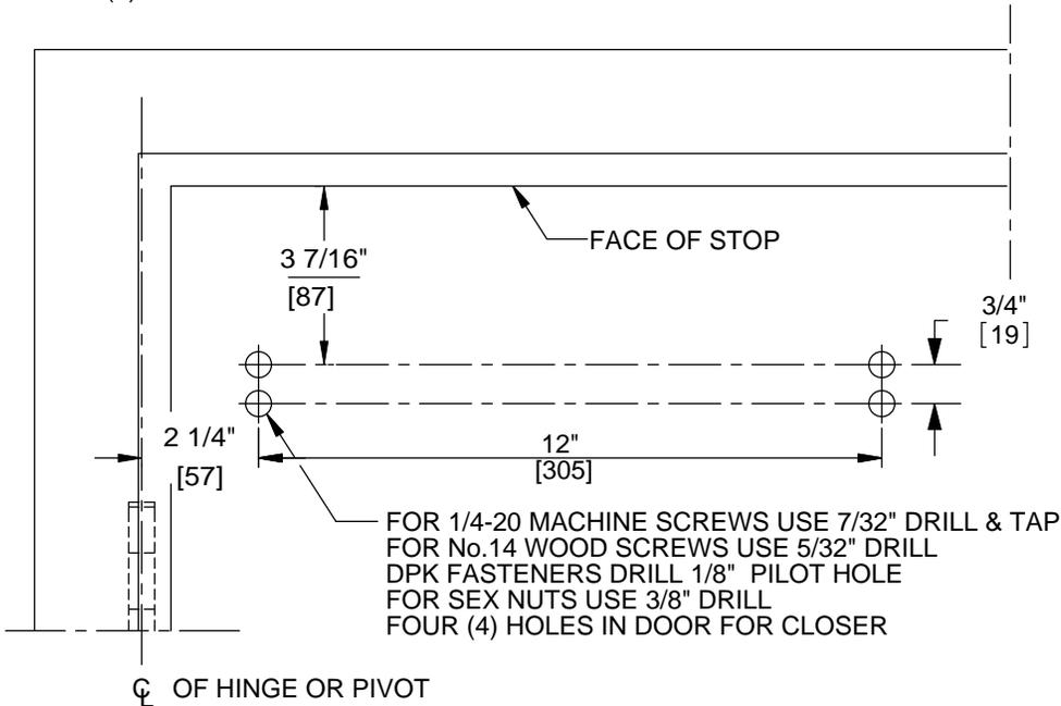
FOR 1/4-20 MACHINE SCREWS USE 7/32" DRILL & TAP
