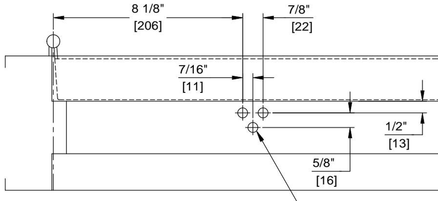
FOR 1/4-20 MACHINE SCREWS USE 7/32" DRILL & TAP
