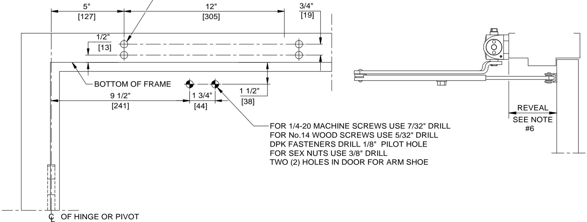
FOR 1/4-20 MACHINE SCREWS USE 7/32" DRILL
