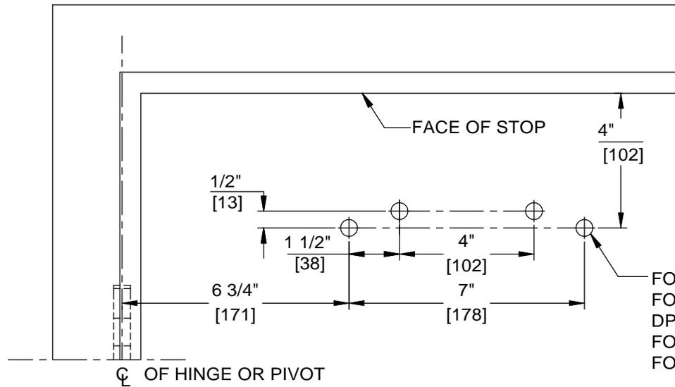
FOR 1/4-20 MACHINE SCREWS USE 7/32" DRILL & TAP
