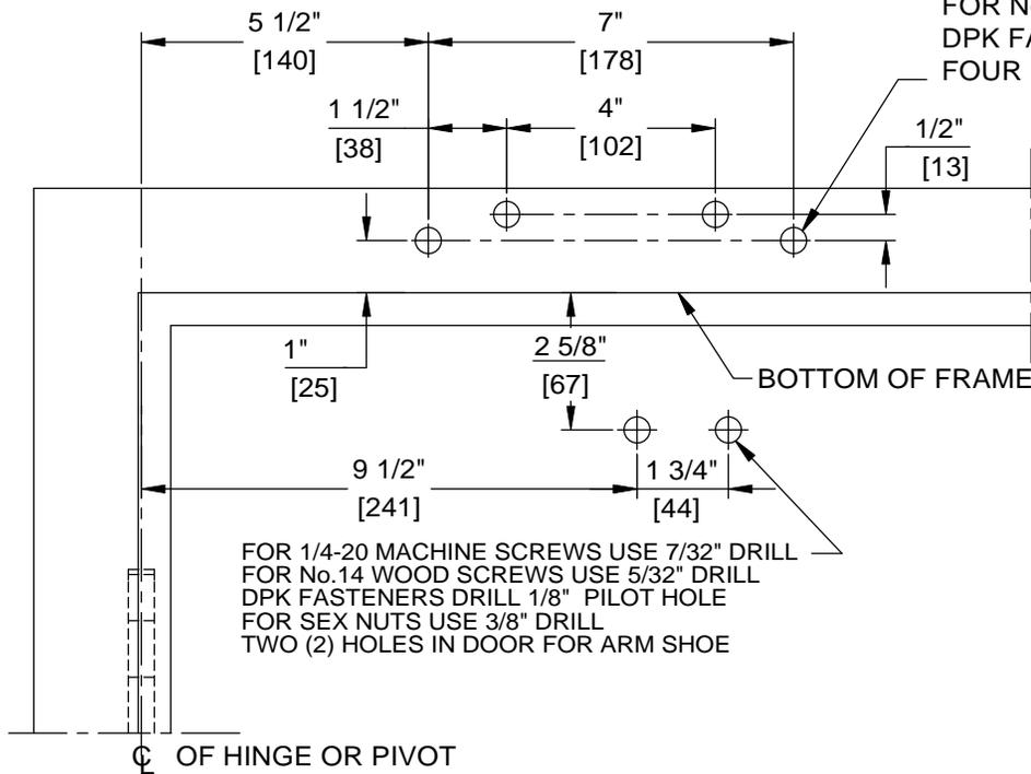
FOR 1/4-20 MACHINE SCREWS USE 7/32" DRILL
