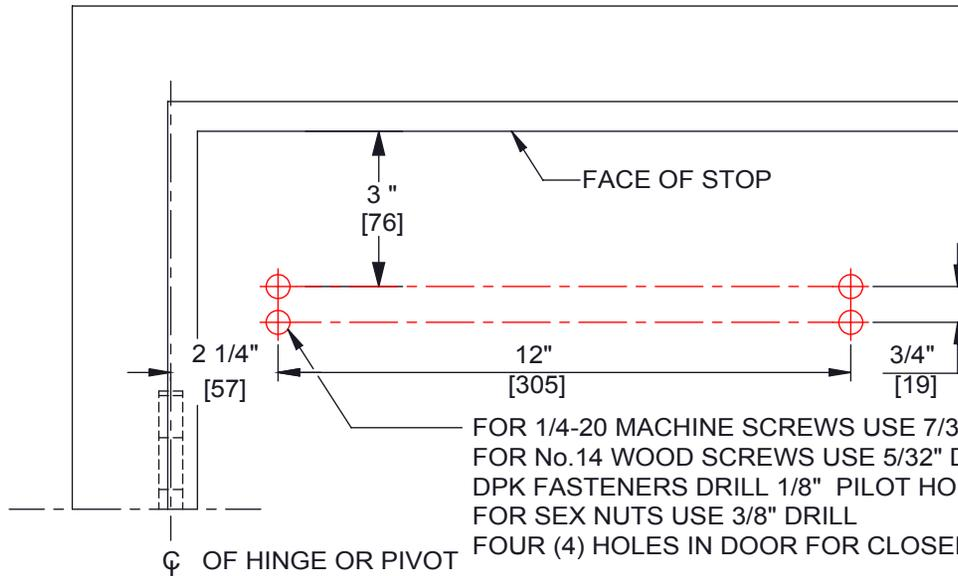
FOR 1/4-20 MACHINE SCREWS USE 7/32" DRILL
