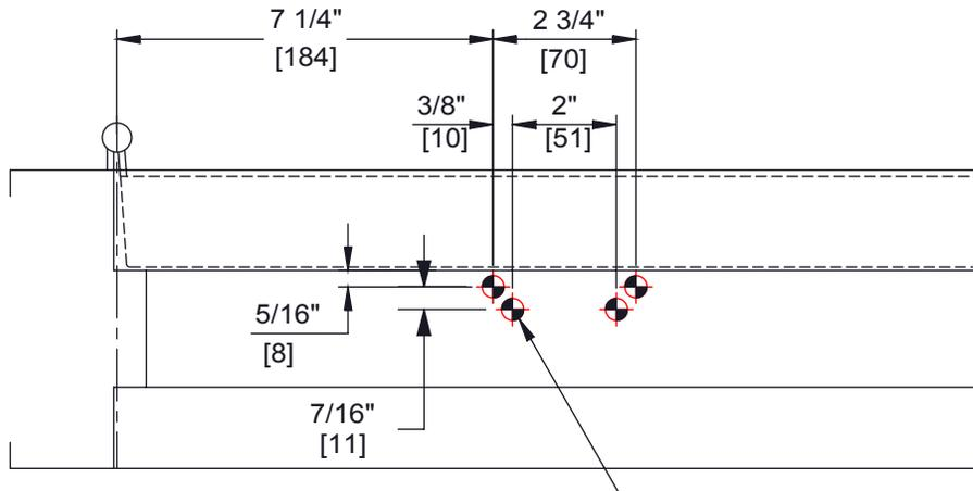
FOR 1/4-20 MACHINE SCREWS USE 7/32" DRILL
