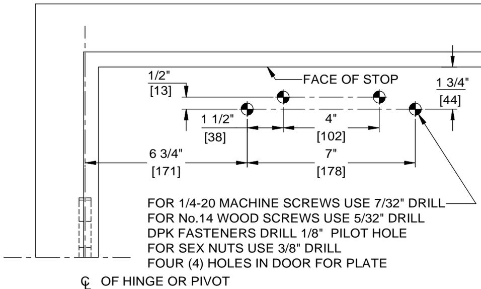
FOR 1/4-20 MACHINE SCREWS USE 7/32" DRILL
