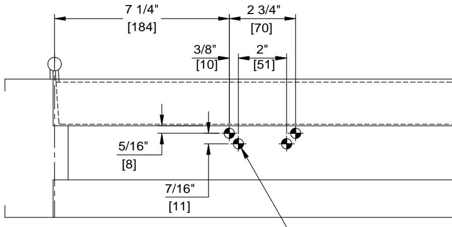
FOR 1/4-20 MACHINE SCREWS USE 7/32" DRILL
