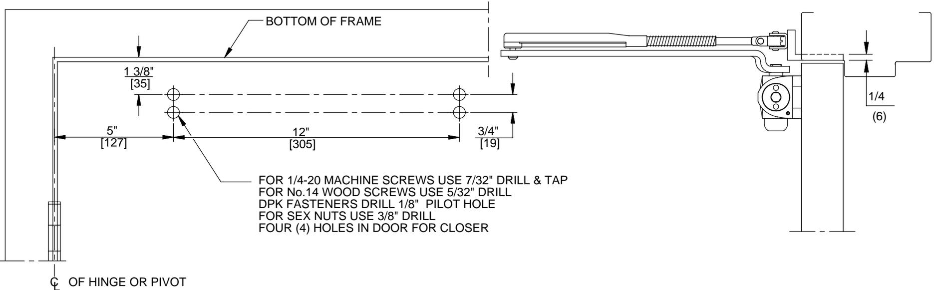
FOR 1/4-20 MACHINE SCREWS USE 7/32" DRILL & TAP
