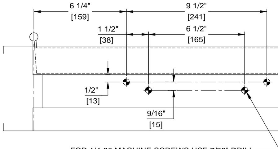
FOR 1/4-20 MACHINE SCREWS USE 7/32" DRILL
