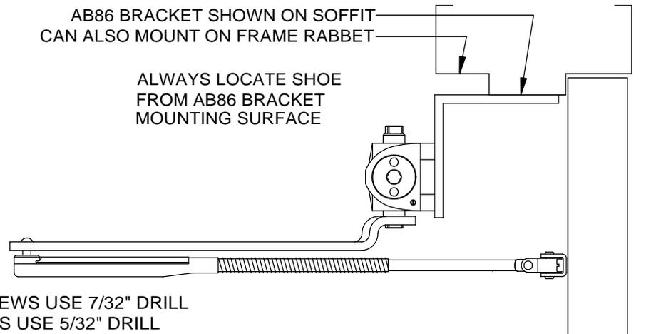
AB86 BRACKET SHOWN ON SOFFIT
