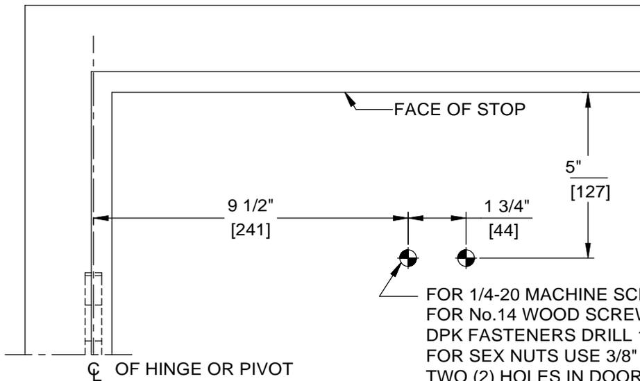
FOR 1/4-20 MACHINE SCREWS USE 7/32" DRILL
