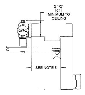
DOOR CLOSER MODELS: 8616 SISJ TOB JAMB INSTALLATION (PUSH SIDE MOUNT) SPRING INTEGRA CUSHION ARM
