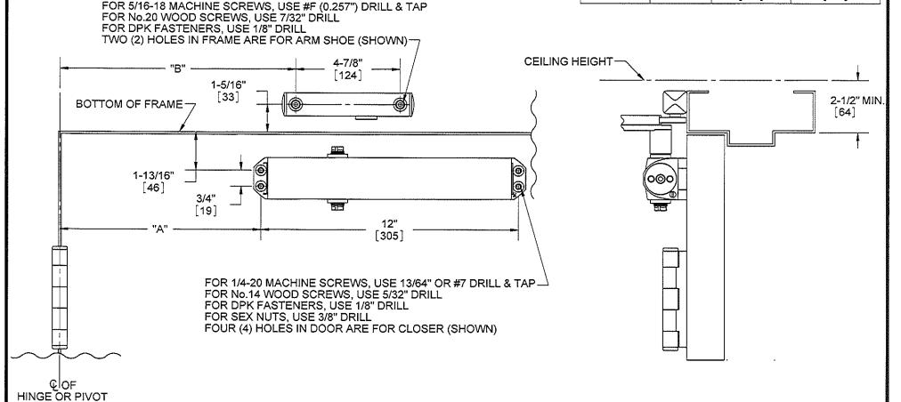
DOOR CLOSER MODELS: 8616 SISH REGULAR INSTALLATION (PULL SIDE MOUNT) SPRING INTEGRA CUSHION ARM
