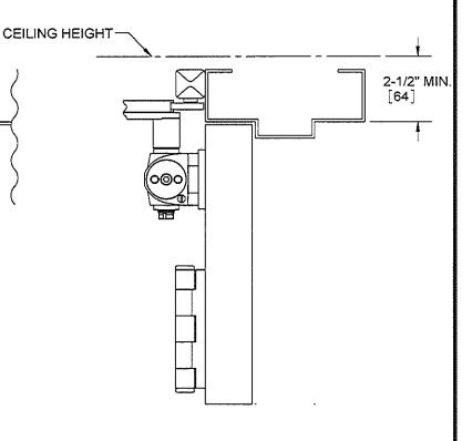
DOOR CLOSER MODELS: 8616 SISH REGULAR INSTALLATION (PULL SIDE MOUNT) WITH BACK PLATES BP86 & BP86FC SPRING INTEGRA CUSHION ARM
