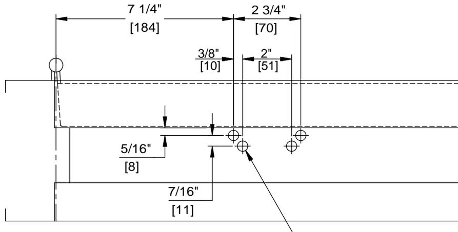
FOR 1/4-20 MACHINE SCREWS USE 7/32" DRILL
