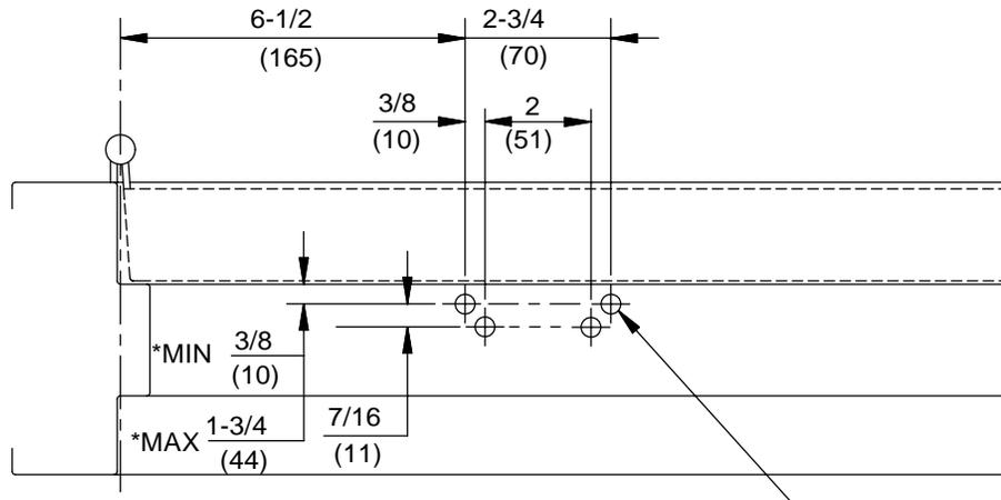
FOR 1/4-20 MACHINE SCREWS USE 7/32 DRILL & TAP
