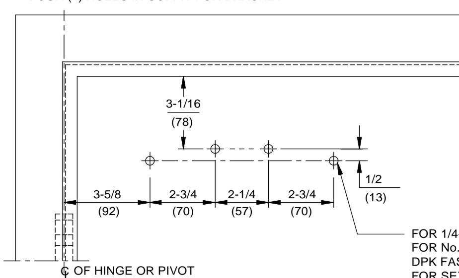
FOR 1/4-20 MACHINE SCREWS USE 7/32" DRILL & TAP
