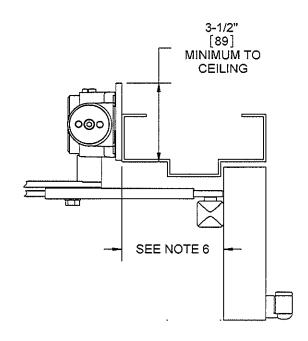
DOOR CLOSER MODELS: 8916 & 8956 SISJ TOP JAMB INSTALLATION (PUSH SIDE MOUNT) WITH BACK PLATE BP89 SPRING INTEGRA CUSHION ARM
