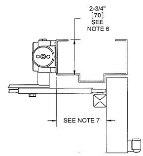
DOOR CLOSER MODELS: 8916 & 8956 SISJ TOP JAMB INSTALLATION (PUSH SIDE MOUNT) SPRING INTEGRA CUSHION ARM
