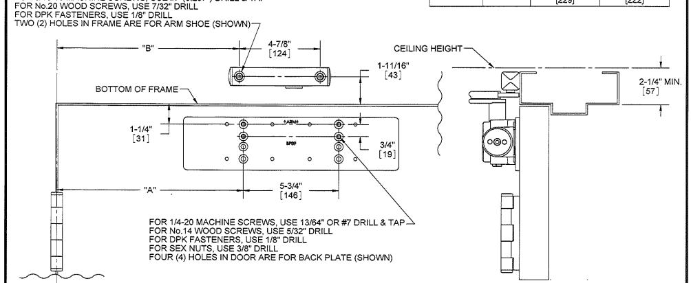
DOOR CLOSER MODELS: 8916 & 8956 SISH REGULAR INSTALLATION (PULL SIDE MOUNT) WITH BACK PLATE BP89 SPRING INTEGRA CUSHION ARM
