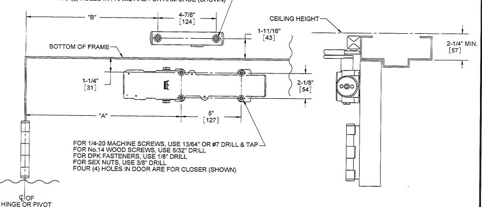
DOOR CLOSER MODELS: 8916 & 8956 SISH REGULAR INSTALLATION (PULL SIDE MOUNT) SPRING INTEGRA CUSHION ARM
