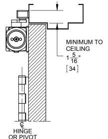
DOOR CLOSER MODEL: TS93 ST TRACK INSTALLATION (PULL SIDE MOUNT)
