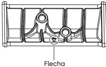
**⚠ PRECAUCIÓN: ajuste los tornillos a mano; no utilice ningún taladro eléctrico. Evite ajustar demasiado para evitar que la rosca se dañe.**
