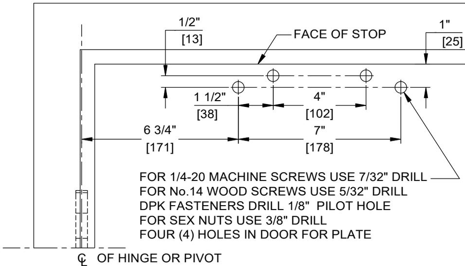
FOR 1/4-20 MACHINE SCREWS USE 7/32" DRILL
