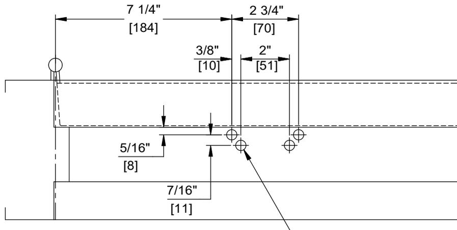
FOR 1/4-20 MACHINE SCREWS USE 7/32" DRILL
