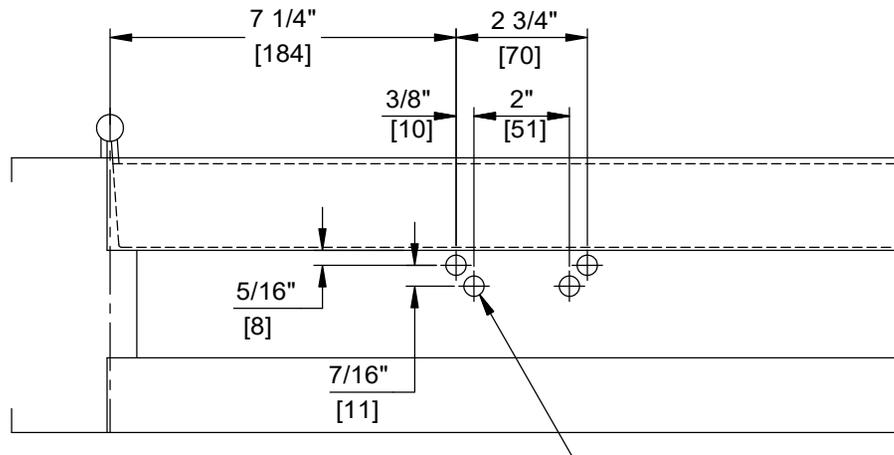
FOR 1/4-20 MACHINE SCREWS USE 7/32" DRILL
