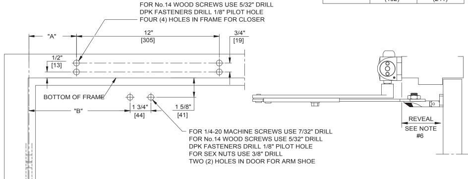
FOR 1/4-20 MACHINE SCREWS USE 7/32" DRILL
