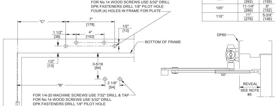
FOR 1/4-20 MACHINE SCREWS USE 7/32" DRILL & TAP
